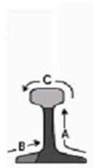
Pjovimo eiliškumas: A – padas + kakliukas; B – kitos bėgio pusės padas; C – bėgio galvutė
