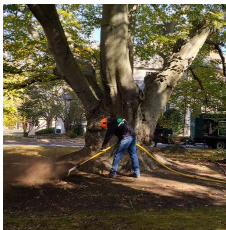
Pav. 1. Polajo purenimo oro kastuvu pavyzdys.
