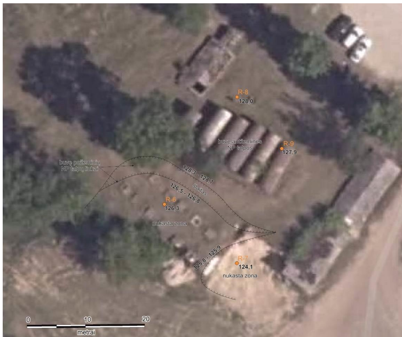
3 pav. Ortofoto buvusios NP bazės teritorija (plotas Nr. 2) iki talpų demontavimo ir grunto nukasimo ribos po demontavimo (gręžiniai R-6 – R-9, juodi skaičiai žymi abs. a. m 2023-05-09)
