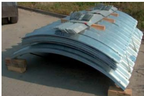
3 pav. Plieninių lakštų sandėliavimas
