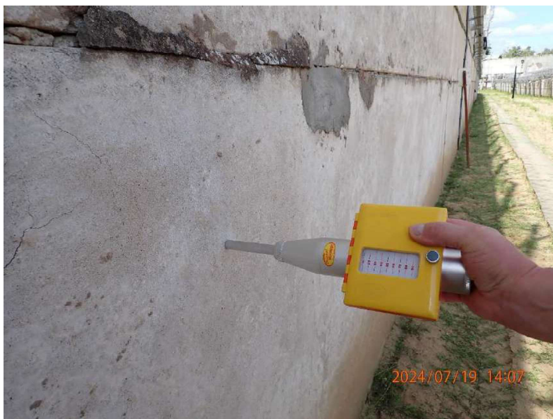
Nuotrauka Nr. 22. Plokštės stiprio nustatymas iš vidinės tvoros pusės
