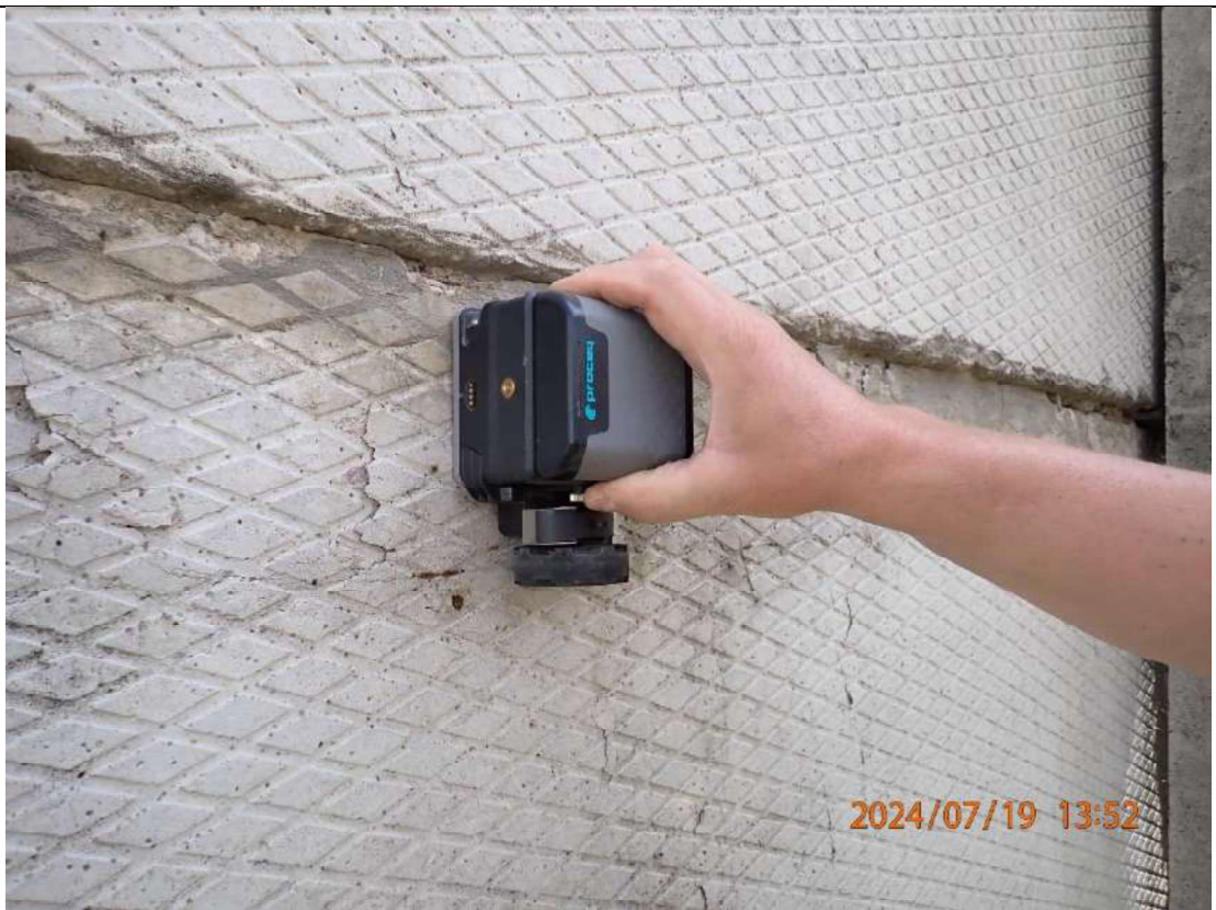
Nuotrauka Nr. 19. Tvoros plokščių skenavimas iš išorinės pusės
