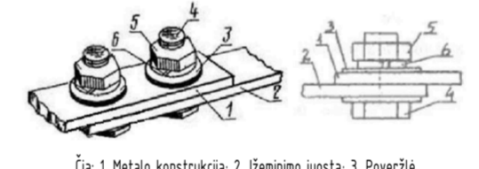
Žemėjimo juostos varžtinis sujungimas prie metalo konstrukcijų (vaizdas 5)
