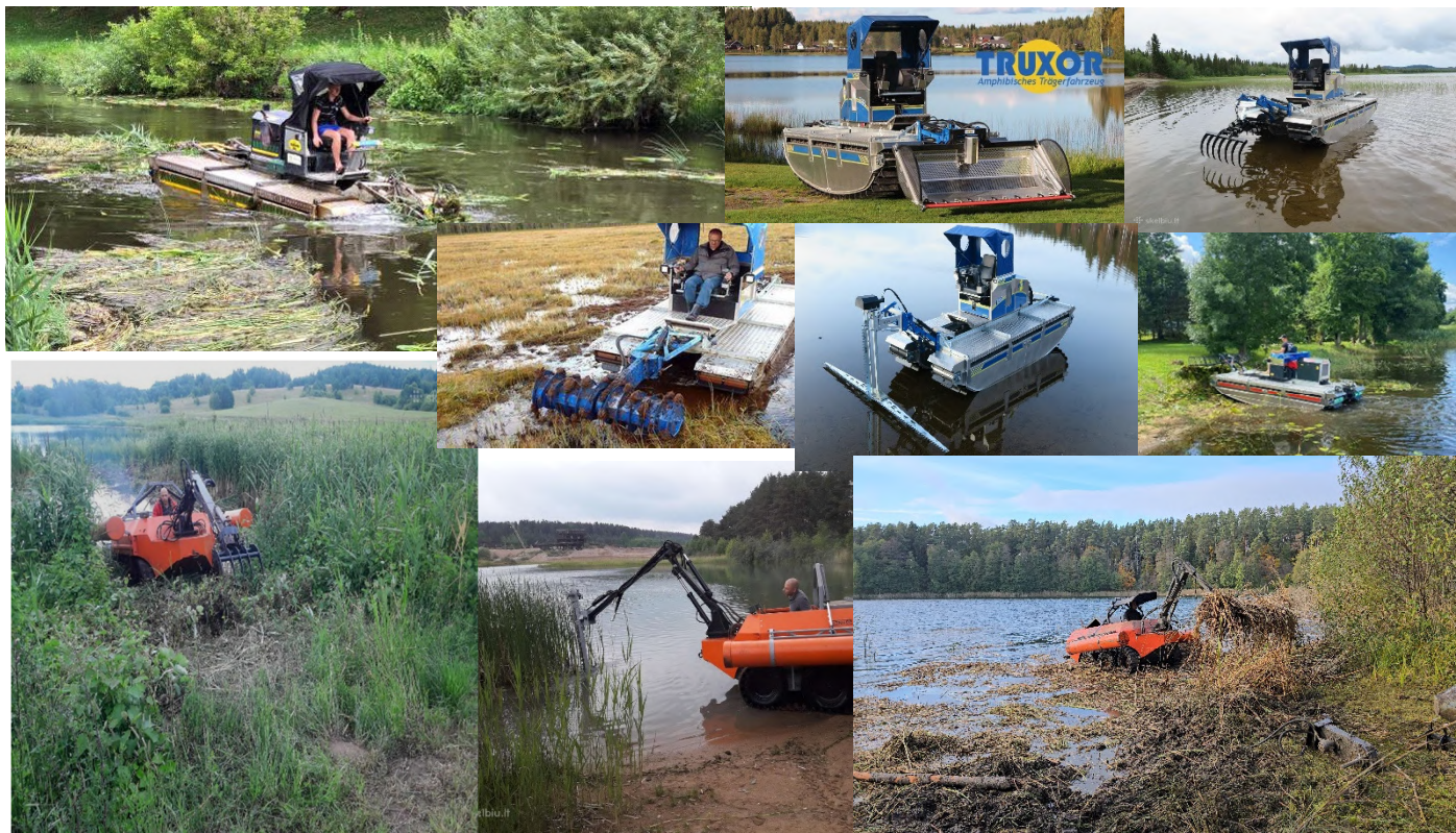
4 pav. Lietuvoje naudojami universalūs vandens telkinių priežiūros kombainai „Truxor“ ir „Conver“ (Gamintojų, vandens telkinių valymo paslaugų teikėjų ir A. Balevičiaus nuotr.)
