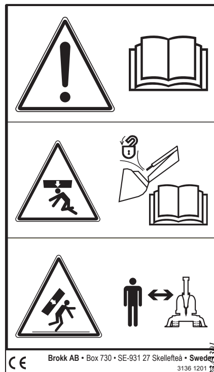
Skaitmuo 124. Įspėjamasis ir informacinis lipdukas ant „Brokk“ kaušo.
