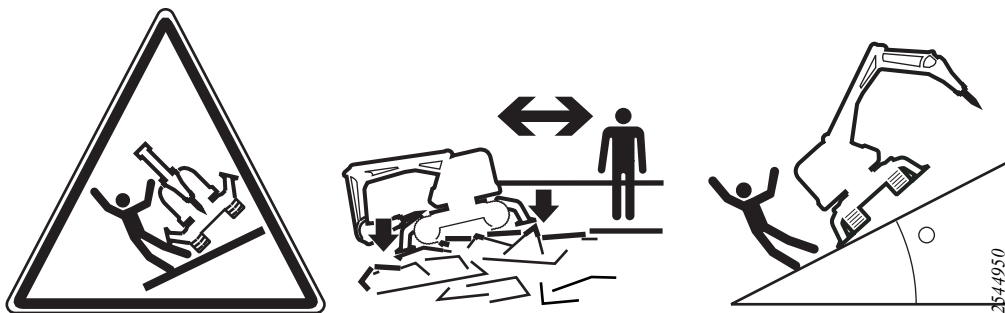
Skaitmuo27. Suspaudimo ar sutraiškymo pavojus. Dirbant turi būti atremtos atramos. Užfiksukite mašiną. Laikykitės atstumo
