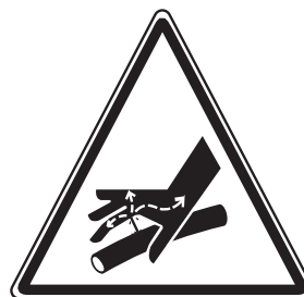
Skaitmuo136. Išleiskite slėgį iš hidraulinės sistemos.
