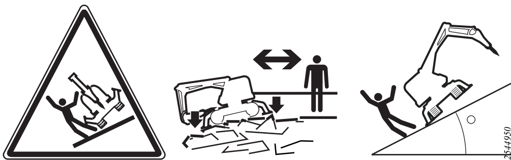
Skaitmuo24. Suspaudimo ar sutraiškymo pavojus. Dirbant turi būti atremtos atramos. Užfiksukite mašiną. Laikykitės atstumo
