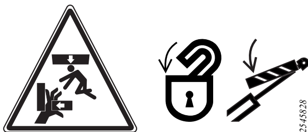
Skaitmuo39. Prieš atjungdami sriegines jungtis ar hidraulinės žarnas, visada mechaniškai užfiksokite judančius komponentus
