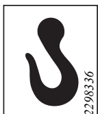
Skaitmuo48. Lipdukas nurodo kėlimo taškų padėtį. Kėlimo taškų skaičius skiriasi pagal mašinos modelį.
