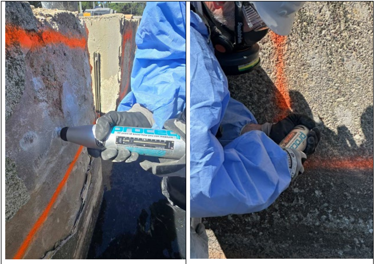
Pav. 7.1 Betono gniuždomojo stiprio instrumentinis tyrimas
