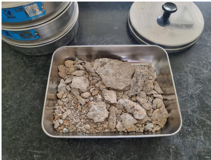
1 pav. Betono cheminės struktūros analizei įvertinti pristatyti betoniniai fragmentai
