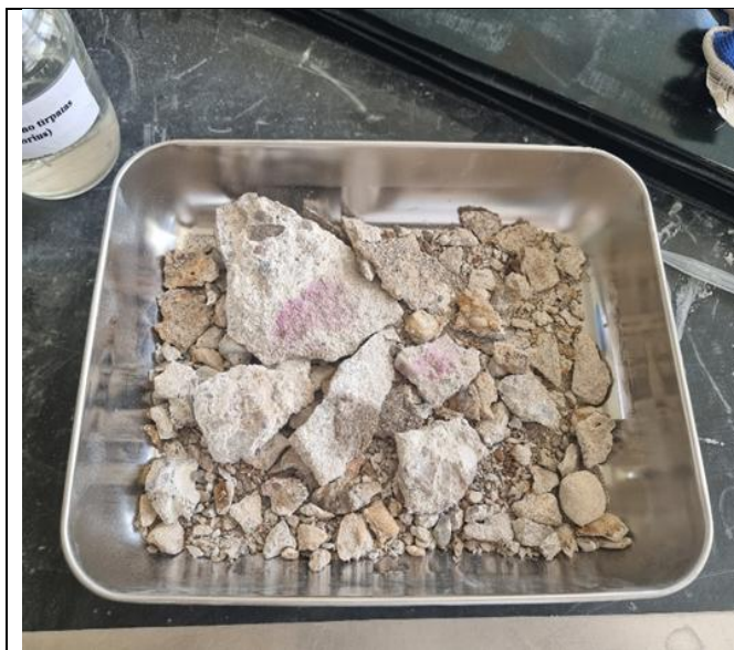
4 pav. Betono fragmentai paveikti 1 % fenolfaleino tirpalu
