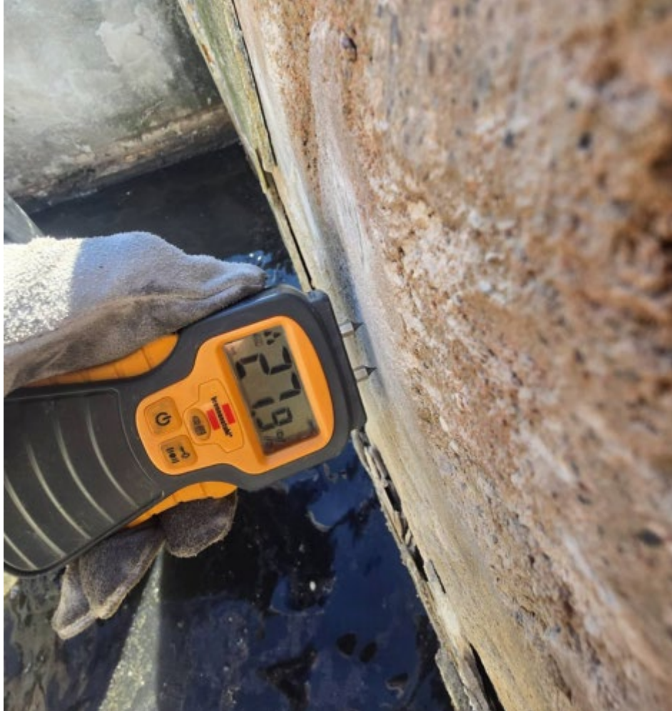
Pav. 7.5 Betono drėgmės kiekio nustatymo instrumentinis tyrimas
