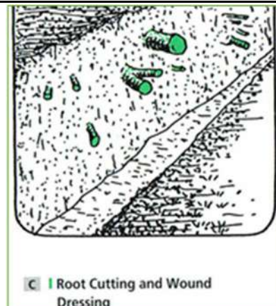
4 pav. Medžių šaknų redukcijos (sutrumpinimo) galimybės ir reikalavimai: 1) minimalus atstumas nuo medžio kamieno – penki kamieno skersmenys; 2) šaknų apsaugos zona (juosta); 3) darbinė erdvė (tranzėja); 4) statinys. Šaknys nupjaunamos ir aptvarstomos. Šaltinis: KŽEG metodinė medžiaga, 2020.
