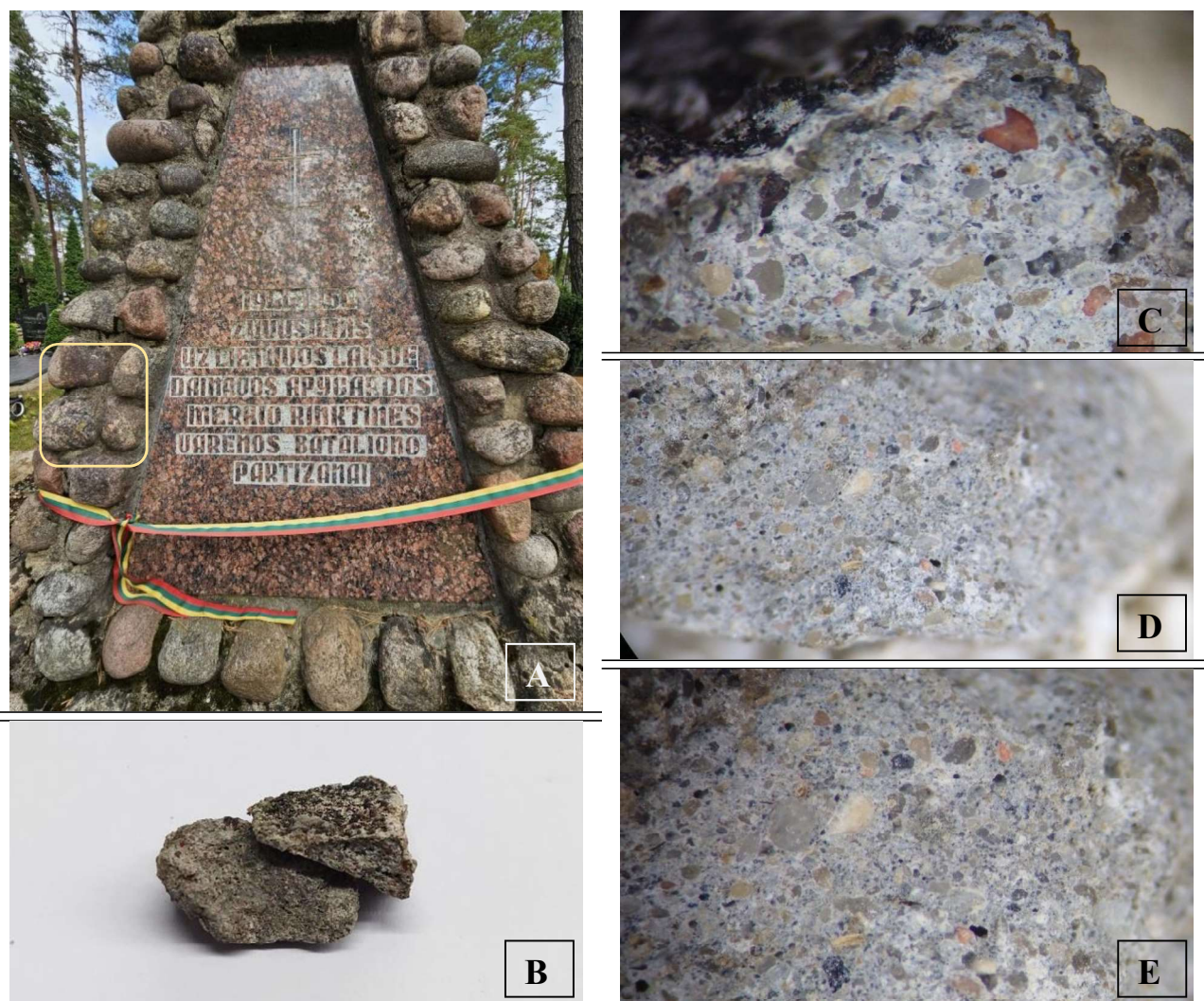
5 pav. Mėginys Nr.4 – T4 (paminklo akmenų siūlių skiedinys): A – mėginio paėmimo vieta; B – bendras mėginio vaizdas; C – mėginio vaizdas pro mikroskopą, x20; D – mėginio vaizdas pro mikroskopą, x20; E – mėginio vaizdas pro mikroskopą, x40.
