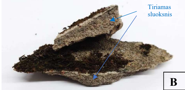
3 pav. Mėginys Nr.2 – T2 (užtrynimasis, apatinis sluoksnis): A – mėginio paėmimo vieta; B – bendras mėginio vaizdas; C – mėginio vaizdas pro mikroskopą, x20; D – mėginio vaizdas pro mikroskopą, x40.
