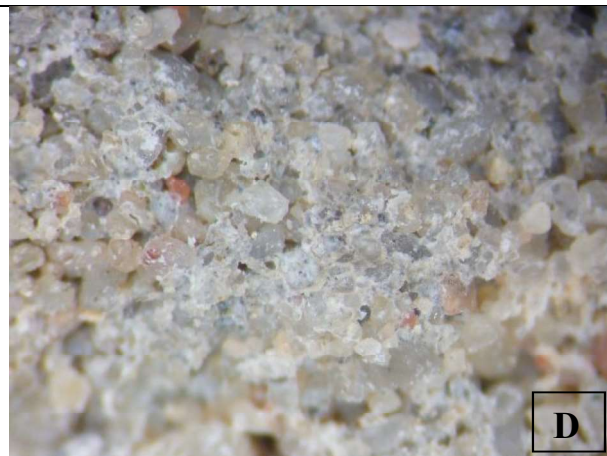
3 pav. Mėginys Nr.2 – T2 (užtrynimasis, apatinis sluoksnis): A – mėginio paėmimo vieta; B – bendras mėginio vaizdas; C – mėginio vaizdas pro mikroskopą, x20; D – mėginio vaizdas pro mikroskopą, x40.
