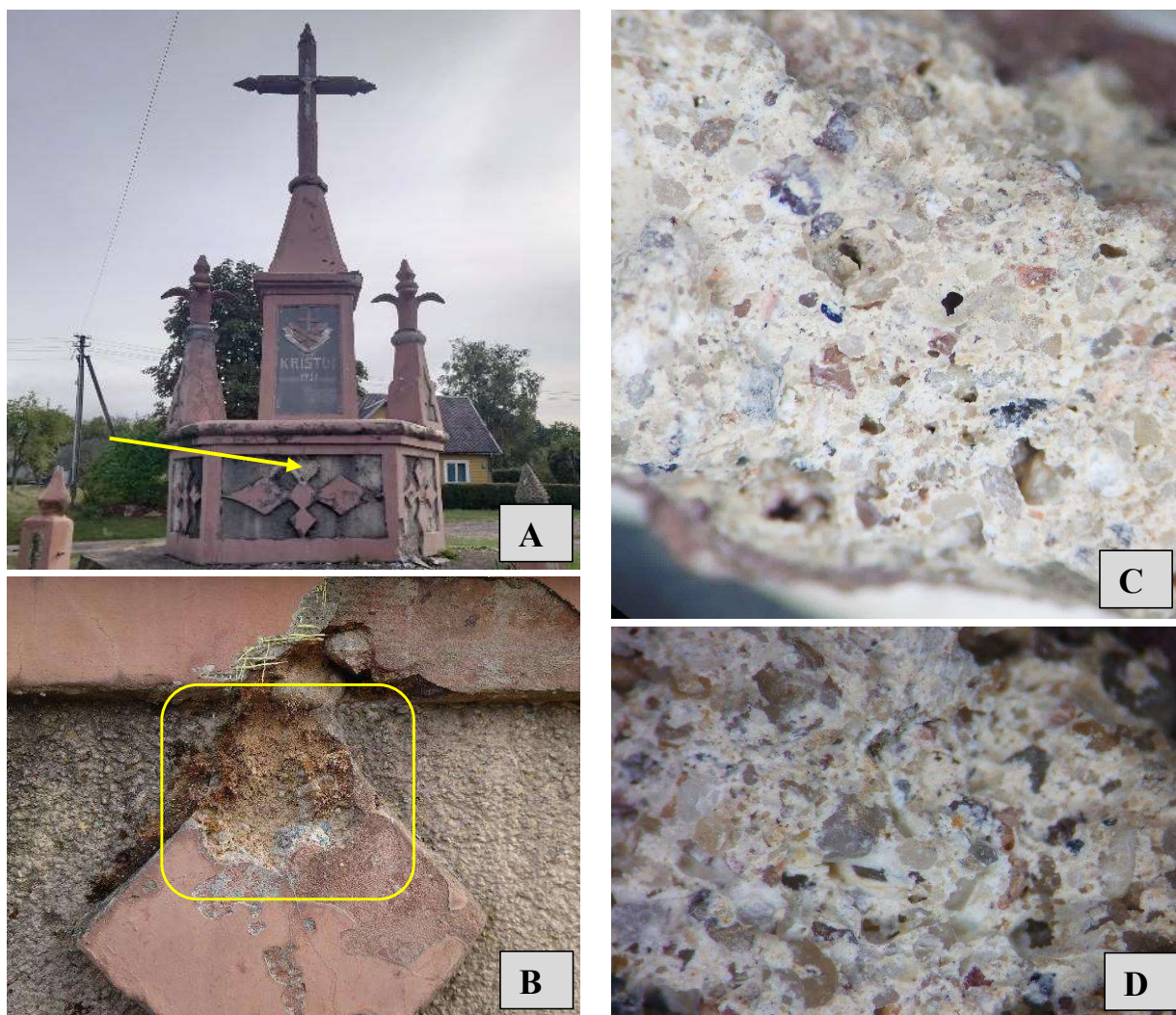
3 pav. Mėginys Nr.2 – T-2 (Pjdestalas, dešinė pusė. Kryžius – apatinis tinko sluoksnis): A, B – mėginio paėmimo vieta; C – mėginio vaizdas pro mikroskopą, x40; D – mėginio vaizdas pro mikroskopą, x20.
