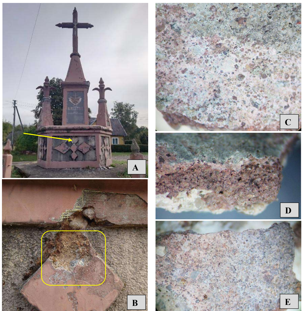
2 pav. Mėginys Nr.1 – T-1 (Pjedestalas, dešinė pusė. Kryžius – spalvotas tinkas): A, B – mėginio paėmimo vieta; C – mėginio vaizdas pro mikroskopą, x40; D – mėginio skerspjūvio vaizdas pro mikroskopą, x40; E – mėginio, iškaitinto 600°C temperatūroje, vaizdas pro mikroskopą, x20.
