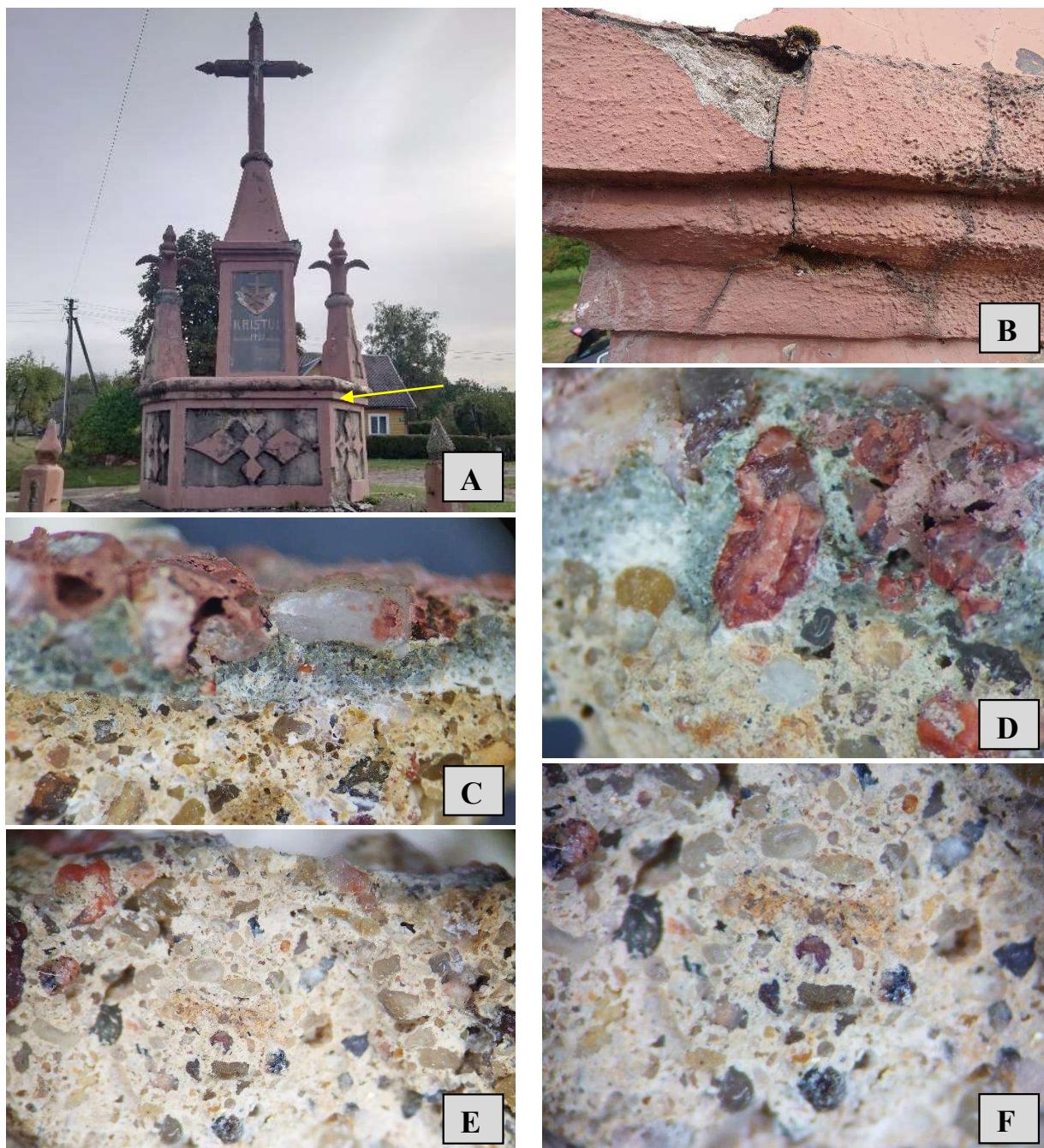
6 pav. Mėginys Nr.5 – T-5 (Karnizas po stogeliu – su raudonais akmenukais): A, B – mėginio paėmimo vieta; C, D – mėginio skerspjūvio vaizdas pro mikroskopą, x40; E, F – mėginio apatinio sluoksnio vaizdas pro mikroskopą, x40.
