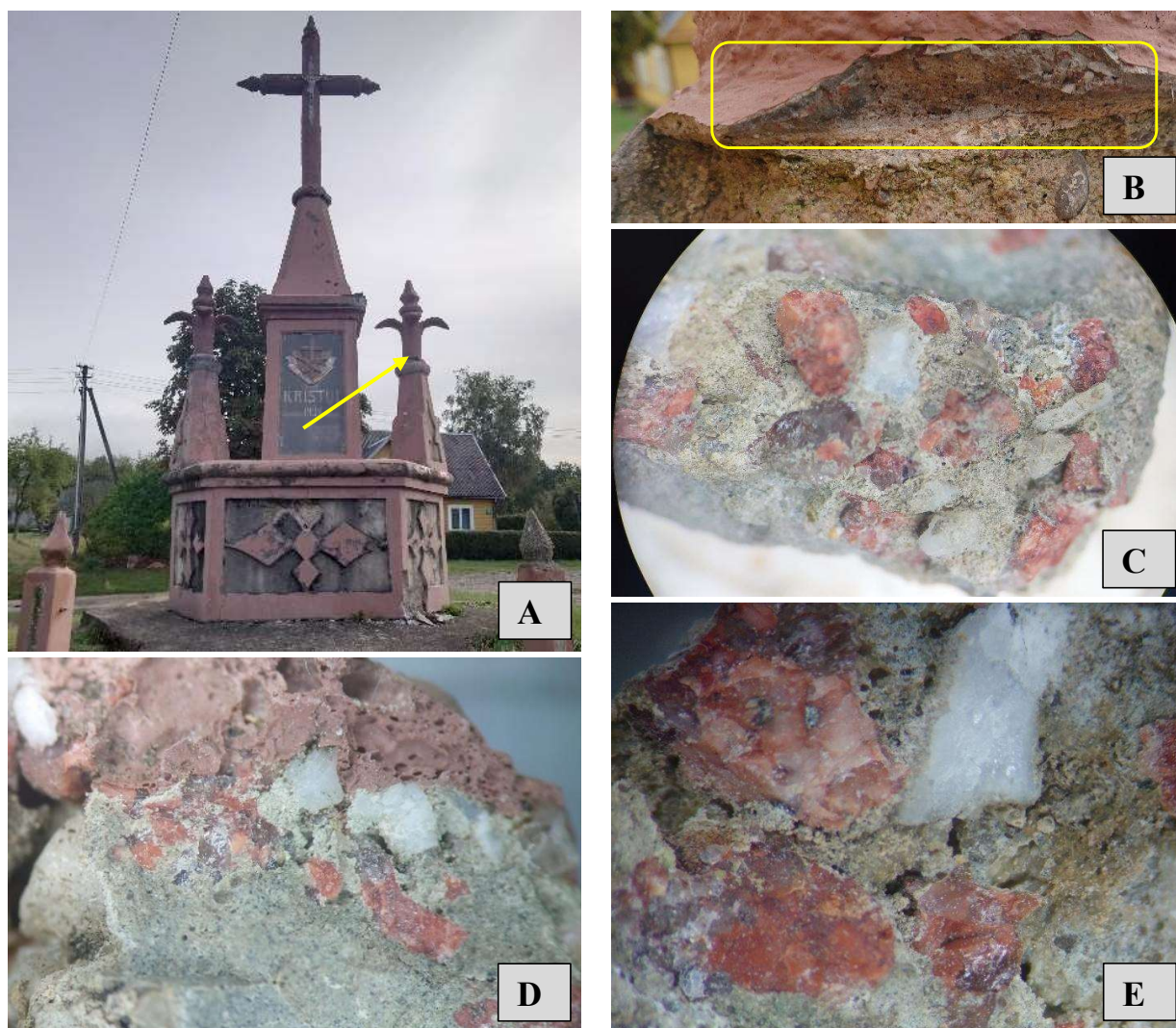
9 pav. Mėginys Nr.8 – T-8 (Dešinysis obeliskas): A, B – mėginio paėmimo vieta; C – mėginio vaizdas pro mikroskopą, x20; D – mėginio skerspjūvio vaizdas pro mikroskopą, x20; E – mėginio vaizdas pro mikroskopą, x40.
