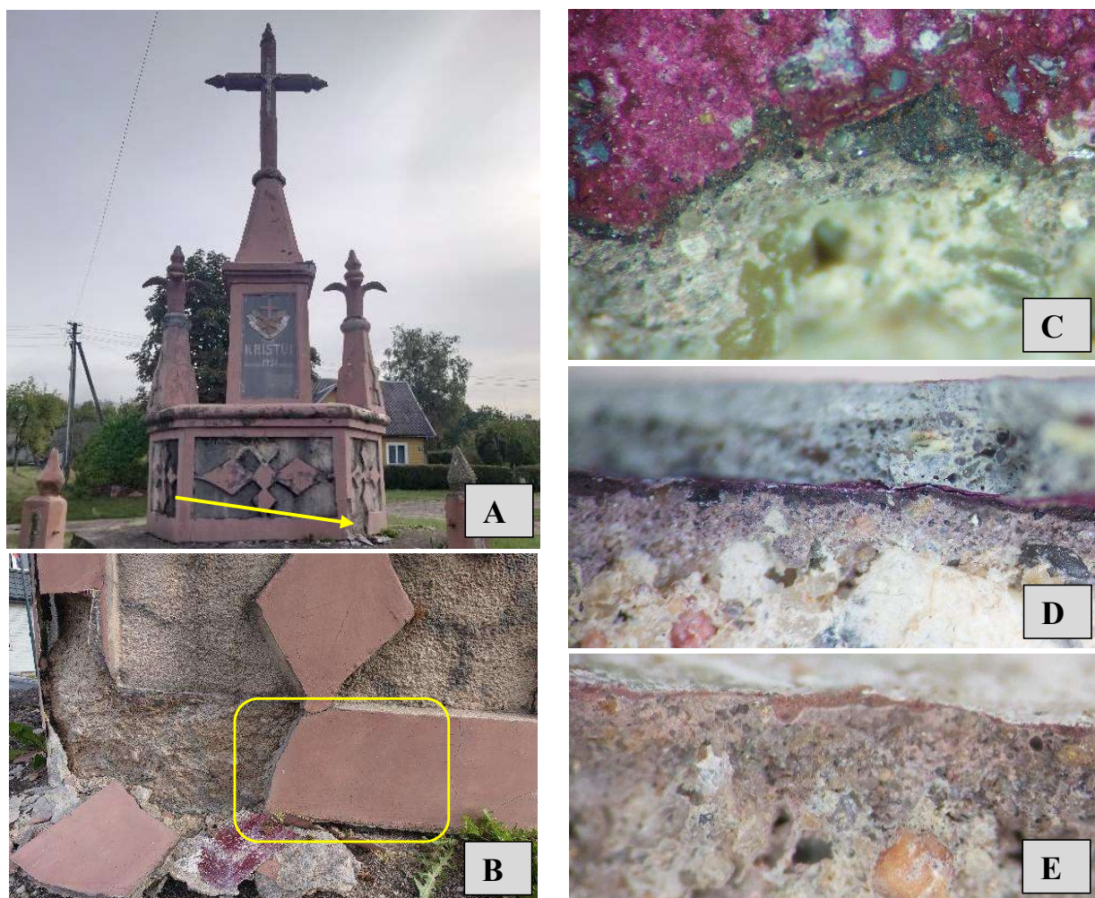
8 pav. Mėginys Nr.7 – T-7 (Pjedestalas, dešinė pusė. Apvadas – spalvotas tinkas): A, B – mėginio paėmimo vieta; C – mėginio vaizdas pro mikroskopą, x40; D – mėginio skerspjūvio vaizdas pro mikroskopą, x40; E – mėginio, iškaitinto 600°C temperatūroje, vaizdas pro mikroskopą.
