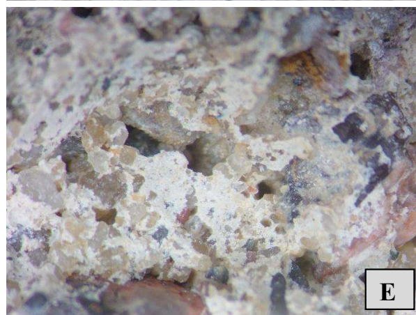
4 pav. Mėginys Nr.3 – T-3 (Pjdestalo apatinis apvadas – apatinis tinko sluoksnis): A, B – mėginio paėmimo vieta; C – mėginio vaizdas pro mikroskopą, x20; D – mėginio vaizdas pro mikroskopą, x20; E – mėginio vaizdas pro mikroskopą, x40.
