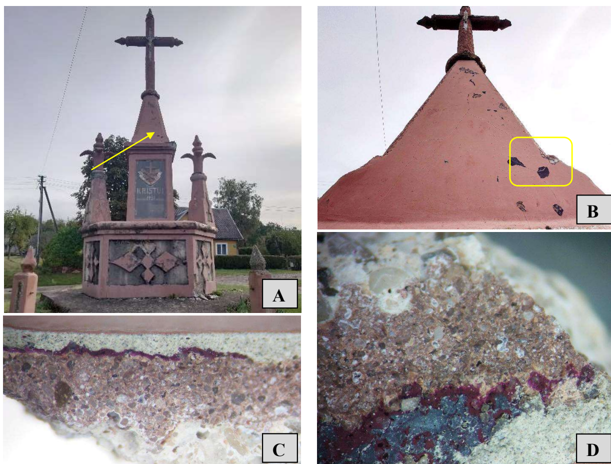
7 pav. Mėginys Nr.6 – T-6 (Stogelis – spalvotas tinkas): A, B – mėginio paėmimo vieta; C – mėginio skerspjūvio vaizdas pro mikroskopą, x40; D – mėginio vaizdas pro mikroskopą, x40.
