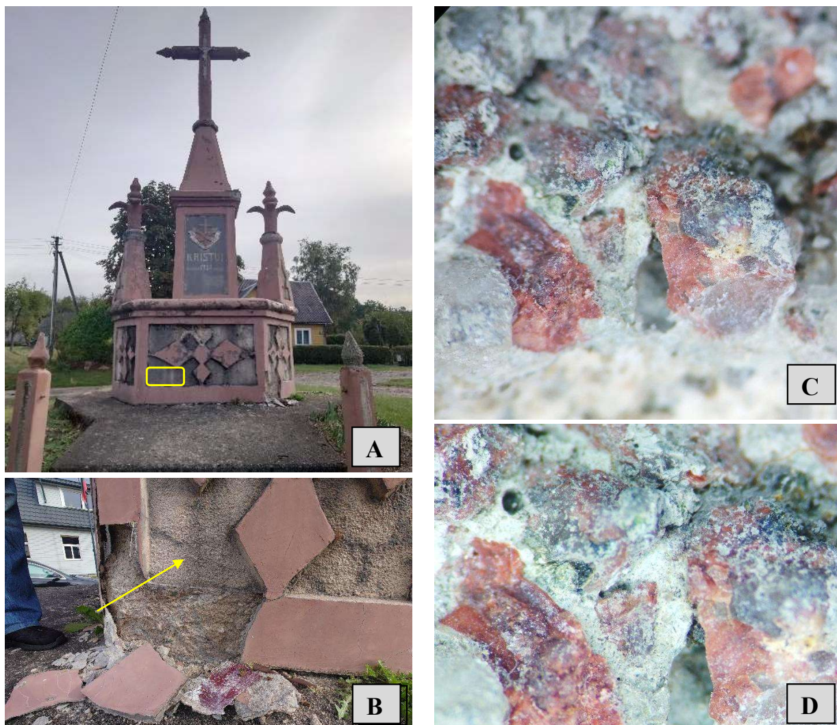
5 pav. Mėginys Nr.4 – T-4 (Pjedašto priekinė dalis – kryžiaus fonas): A, B – mėginio paėmimo vieta; C – mėginio vaizdas pro mikroskopą, x20; D – mėginio vaizdas pro mikroskopą, x40.
